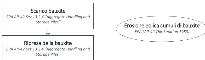
Figura 7. Sorgenti emissive del ciclo di movimentazione della bauxite
